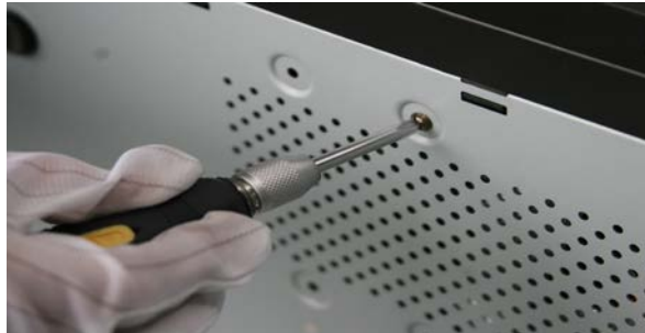
Рис.2.1. Последовательность действий при установке жесткого диска
