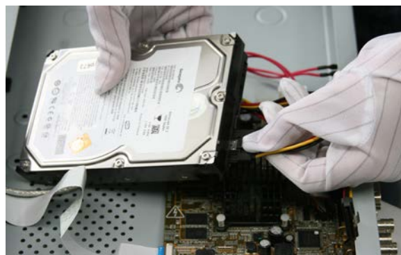
Рис. 2.3. Последовательность действий при установке жесткого диска
